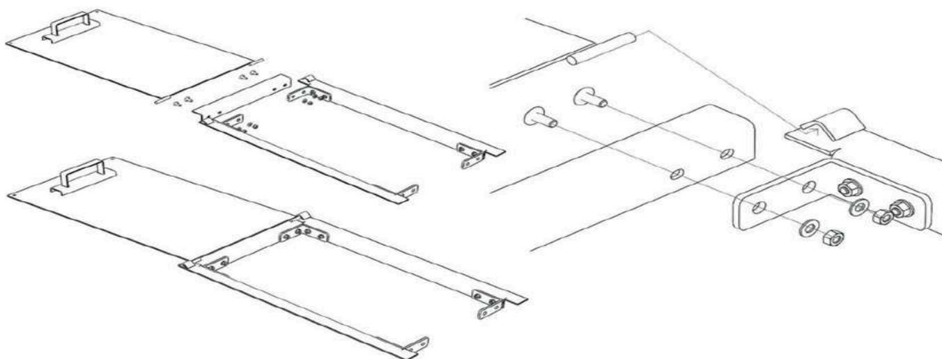
**\*Avertissement :** La galvanisation à chaud est susceptible de produire des déformations sur les pièces métalliques. Une parfaite planéité des ouvrants ne peut donc être garantie. Notre contrôle qualité veille à ce que les ouvrants soient ajustés et qu'ils ne produisent jamais de ressaut supérieur à 2 centimètres. Aucune réclamation ne pourra être acceptée sur les déformations en deçà de ce seuil de tolérance.
